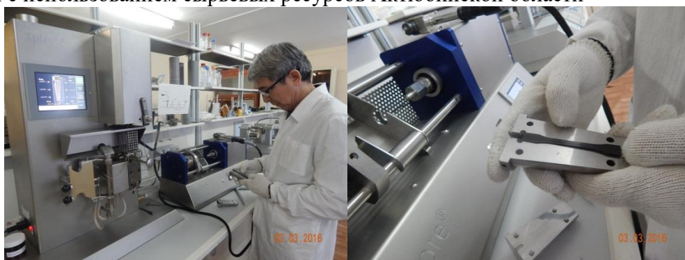
DSM Xplore, Нидерланды – Зертханалық экструдер (Микрокомпаундер)
